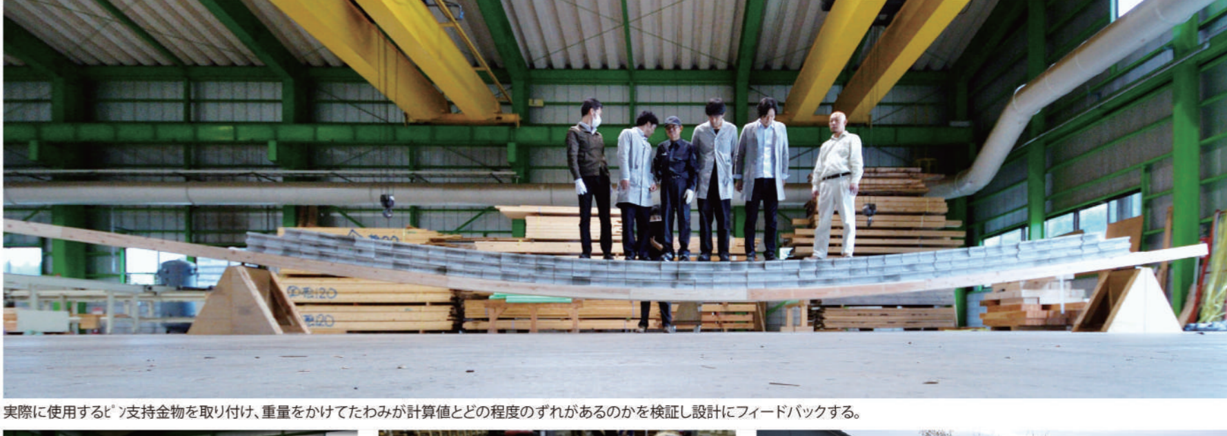
実際に使用する際の支持物を取り付け、重量をかけてたわみが計算値とどの程度のずれがあるかを検証し設計にフィードバックする。
