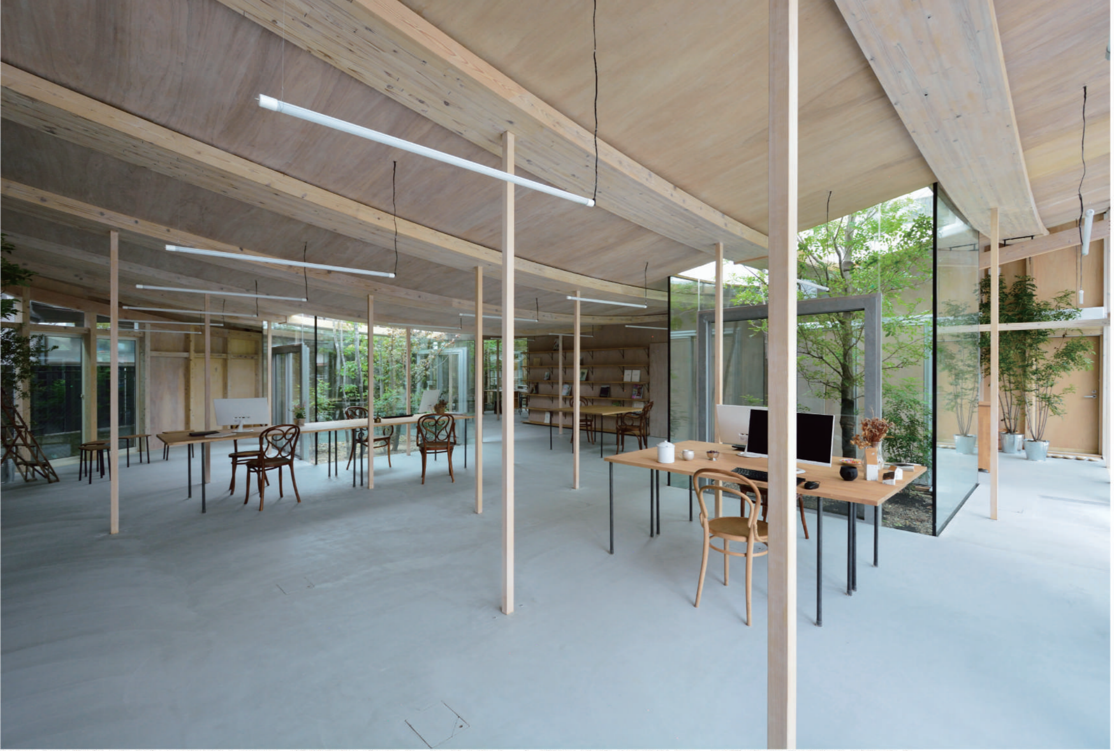
扁平した梁を50×50の柱で引き下ろしている。積載荷重と柱にかかったプレテンションが常にバランスを取り合い、柱が圧縮を受けにくい設計した。
