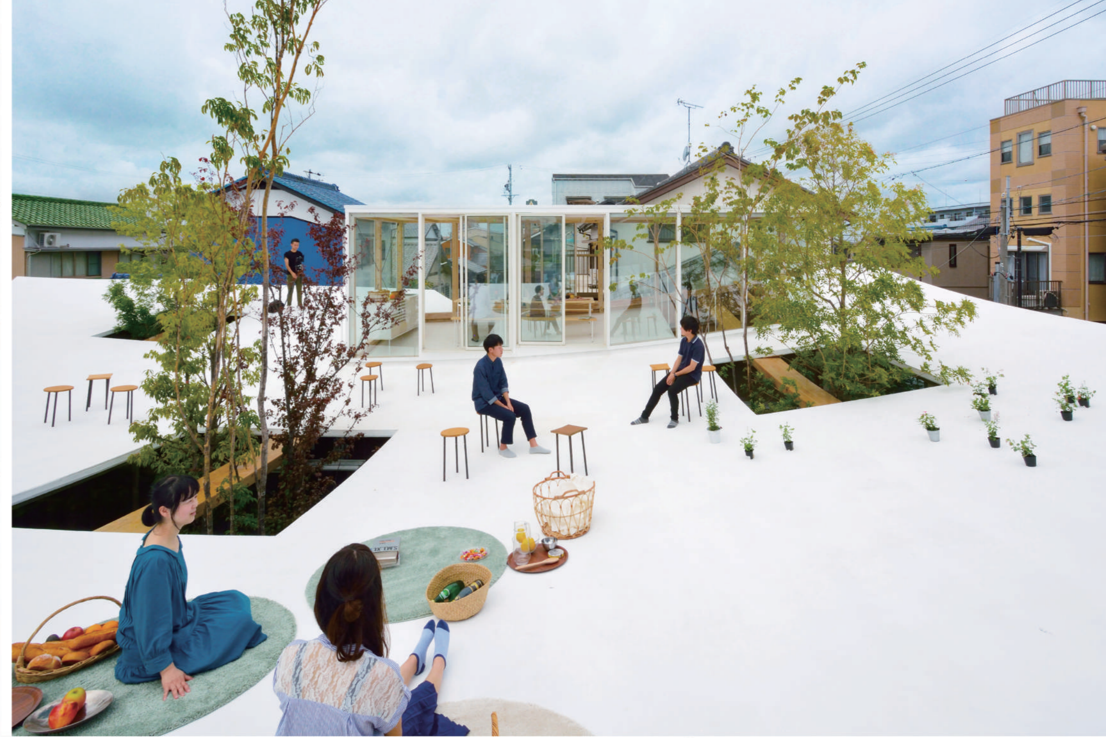
柔らかくつまれたような形状の屋上は最低点と最高点で2,400mmの高低差を持つ。屋上は最大110人(40kg/m 2 )が載ってもテンションが抜けないように設計されている。
