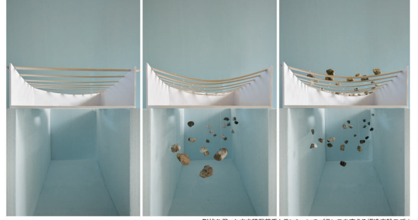
扁平した梁を50×50の柱で引き下ろしている。積載荷重と柱にかかったプレテンションが常にバランスを取り合い、柱が圧縮を受けにくい設計した。
