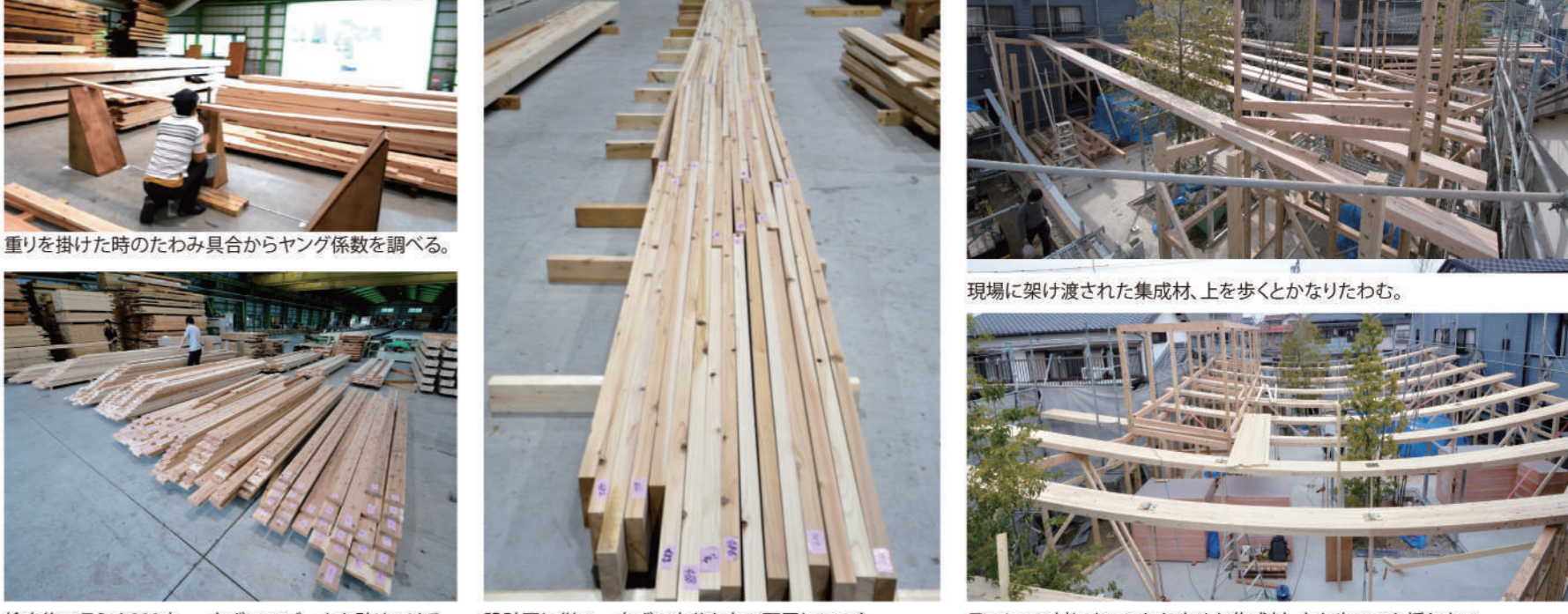
実際に使用する際の支持物を取り付け、重量をかけてたわみが計算値とどの程度のずれがあるかを検証し設計にフィードバックする。
