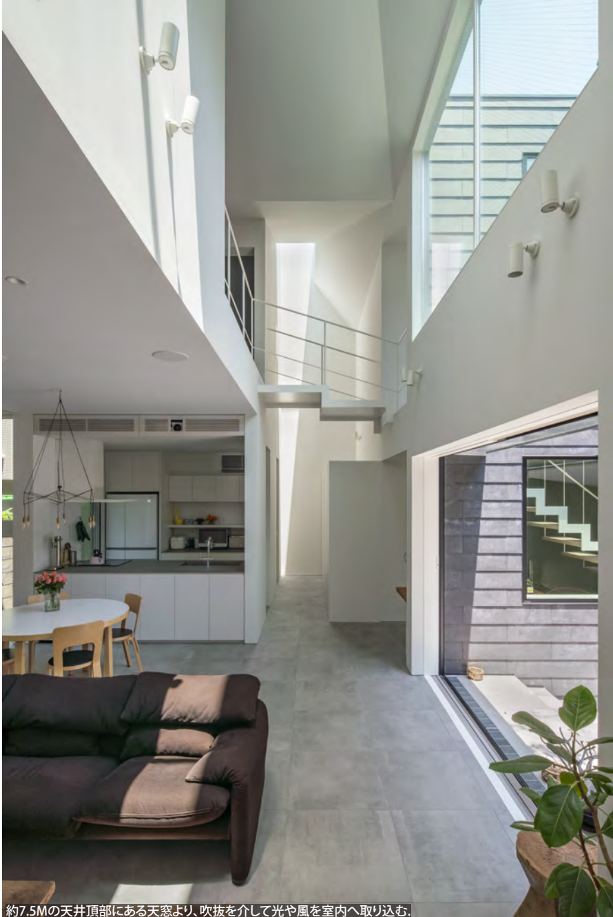
約7.5Mの天井頂部にある天窗より、吹抜を介して光や風を室内へ取り込む。
